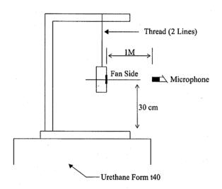
1 METER FROM MICROPHONE TO FAN INTAKE
