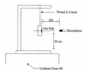
1 METER FROM MICROPHONE TO FAN INTAKE
